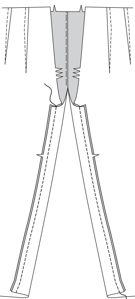
21. Verbleibende Schrittnaht bis zum Passzeichen im Vorderteil steppen. Nochmals mit 6 mm Abstand auf der Nahtzugabe entlang der Bogenkante steppen. Nahtzugaben zurückschneiden.
