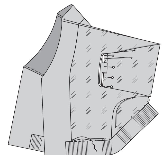
**STEPPEN** Sie auf der AUSSENSEITE die Vorder- und Unterkanten des vorderen Besatzes AB, steppen Sie weiter durch die innere Bandnaht ab, wobei die gebügelte Kante des Futters auf der INNENSEITE mitgefasst wird.
