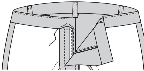
Machen Sie ein Knopfloch im rechten Bund an der Markierung. Auf der Außenseite nähen Sie den Riegel an den rechten Bund am kleinen Punkt, wie gezeigt. Lappen Sie die Öffnungskanten, wobei die Mitten übereinstimmen. Verwenden Sie das Knopfloch als Führung und machen Sie auf der Innenseite eine Knopfmarkierung in den linken Bund. Nähen Sie den Knopf an der Markierung. Nähen Sie auf der Innenseite einen Haken an den linken Bund an einem kleinen Punkt.
