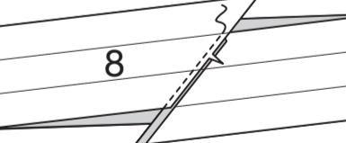
Schneiden Sie, beginnend an einem verlängerten Ende, entlang der Schnittlinie, so dass ein durchgehendes Schrägband entsteht. Schneiden Sie das Ende wie gezeigt ab.
