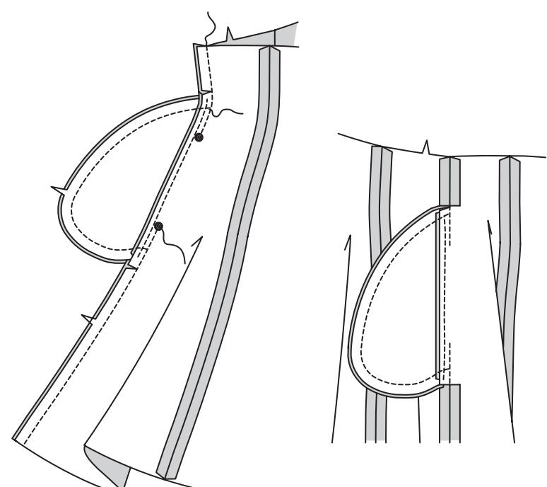
**14.** Den Rock auf das Oberteil aufstecken, die Mitten und Nähte treffen jeweils entsprechend aufeinander. Steppen, die Naht in der vorderen Mitte am großen Punkt unterbrechen, dabei darauf achten, dass die vordere Nahtzugabe nicht mitgefasst wird. Nahtzugaben nach unten bügeln.
