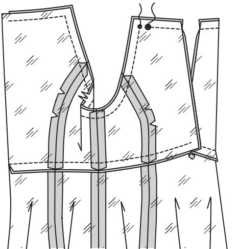
**19.** Die vorderen Öffnungskanten steppen, die Naht in der vorderen Mitte am großen Punkt unterbrechen. Zurückschneiden.
