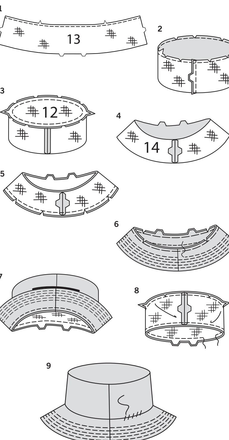
**1.** Tragen Sie die **EINLAGE** auf die Krone (13) auf. Nähen Sie mit der Maschine 1 cm von der einzelnen eingekerbten Kante der Krone entfernt.
