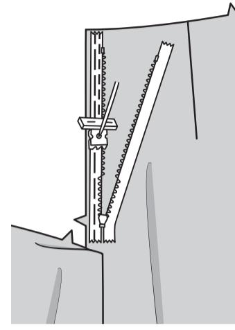
Stecken Sie die verbleibende Hälfte des Reißverschlusses auf der LINKEN Seite der Reißverschlussöffnung auf die gleiche Weise fest. Heften Sie mit der Hand entlang der Mitte des Bandes. Positionieren Sie den Reißverschlussfuß am oberen Ende des Reißverschlusses mit der LINKEN Rille über der Spule. Nähen Sie entlang des Bandes bis zur unteren Kerbe, halten Sie dabei den Rock frei. Steppen Sie mit Rückstichen zur Verstärkung.
