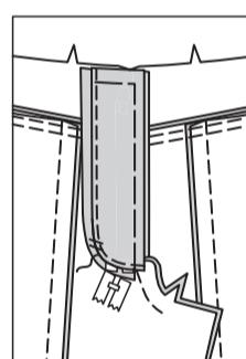
Nähen Sie auf der AUSSENSEITE mit der Maschine einen Riegel über das untere Ende der Schlitzleiste durch alle Dicken hindurch.
