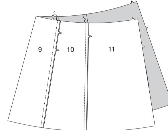
Stecken Sie die Oberkante des Rockfutters auf die Unterkante des Oberteilfutters, wobei die Kerben, die vorderen Mitten, Kerben und Nähte übereinstimmen und die hinteren Öffnungskanten gerade sind. Verteilen Sie die Kräuseln. Nähen Sie, ohne das Kleid zu berühren, ggf. mit einem Reißverschlussfuß. Bügeln Sie die Naht zum Oberteilfutter hin.
