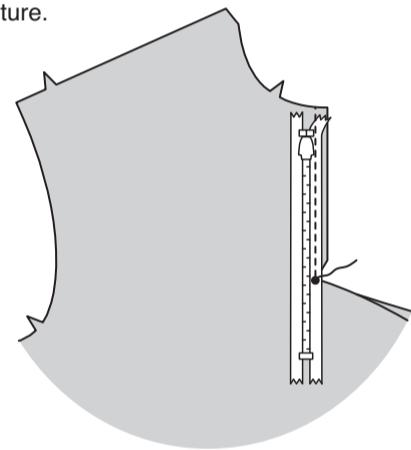
Ouvrez la fermeture. Retournez vers le bas la moitié DROITE du devant sur le petit cercle. Bâtissez à la machine de la même façon l'autre moitié de la fermeture sur l'ouverture de la fermeture devant GAUCHE. Retournez et vérifiez que les bords de l'encolure soient alignés. Retournez et piquez le long du faufil.
