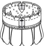
Auf der AUSSENSEITE die Hutoberseite dicht an der Nahtlinie durch alle Dicken hindurch KNAPPKANTIG STEEPEN.
