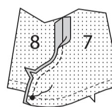
Stecken Sie das Innenbein auf das Außenbein an den hinteren Kanten. Nähen Sie von der oberen Kante bis zum großen Punkt, wobei Sie am Punkt absteppen, um die Naht zu verstärken.
