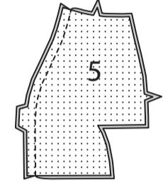
Nähen Sie die ABNÄHERNAHT(-e) vom äußeren kleinen Punkt bis zur Spitze und stecken Sie am äußeren kleinen Punkt zurück, um die Naht zu verstärken. Bügeln Sie die Naht auf.
