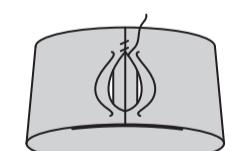
Stecken Sie die Vorderseite des Flügelssets auf die Rückseite des Bandes RECHTS AUF RECHTS. Heften Sie das Band wie gezeigt in der hinteren Mitte an den oberen und unteren Kante des Flügelssets fest.
