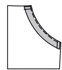
**STEPPEN** Sie die Taschenöffnung **AB**. Nähen Sie entlang der Nahtlinie an der Seite und den unteren Schnittkanten.
