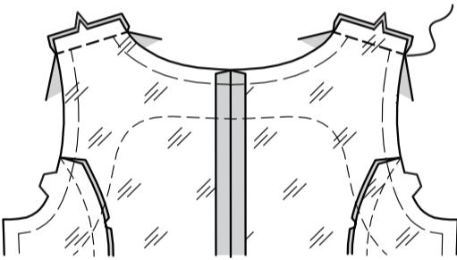
Stecken Sie den Besatz/ das Futter auf das Top RECHTS AUF RECHTS, wobei die Mitten und Schulternähte übereinstimmen und die Schnittkanten gerade sind. Nähen Sie das Futter an das Top, lassen Sie dabei die Seitennähte zum Wenden offen. **BESCHNEIDEN SIE DIE NÄHTE** und die Ecken; schneiden Sie die Kurven ein.
