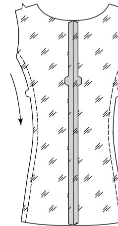
Stecken Sie RECHTS AUF RECHTS das seitl. Rückenteil an die Seitenkanten des Rückenteils, wobei die Kerben übereinstimmen. Schneiden Sie falls erforderlich an den Steppnähten ein. Heften. Nähen Sie. Bügeln Sie die Naht zum Rückenteil hin.
