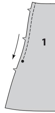
Nähen Sie ein Futterteil der TASCHE (3) an jeder Seite mit einer 6 mm langen Naht auf das Vorderteil.
