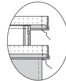
Wenden. Bügeln Sie. **SÄUMEN** Sie die gebügelte Kante über die Naht und die Zusatzkanten zusammen.
