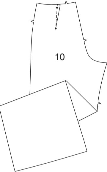
Nähen Sie das Rückenteil und das VORDERTEIL (9) am Innenbein, dehnen Sie dabei das Rückenteil so, dass das Vorderteil zwischen Oberkante und Kerbe passt.
