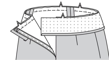
Rechts auf rechts den Bund entlang der Faltlinie falten. Nähen Sie die Enden. **BESCHNEIDEN SIE DIE NAHT**.
