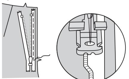
Schließen Sie den Reißverschluss. Stecken Sie das restliche Reißverschlussband an der rechten hinteren Öffnungskante und platzieren Sie die Reißverschlusszähne auf der Nahtlinie.
