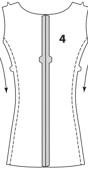
**STEPSEN** Sie die Seitenkanten des rückw. Futters in der Pfeilrichtung **FEST**. Nähen Sie die hintere Mittelnaht der Rückenteile RECHTS AUF RECHTS.
