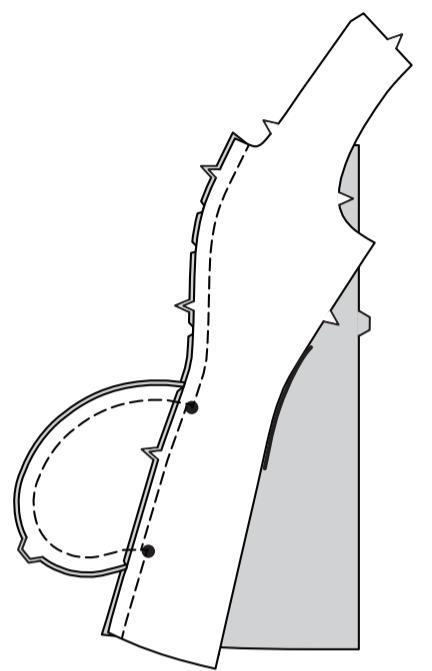
Stecken Sie RECHTS AUF RECHTS das SEITL. RÜCKENTEIL (5) an die Seitenkanten des Rückenteils, wobei die Kerben übereinstimmen. Schneiden Sie zur festen Steppnaht ein, falls erforderlich. Heften. Nähen Sie. Bügeln Sie die Naht zum Rückenteil hin. Nähen Sie das Vorderteil an den Schulternähten auf das Rückenteil.
