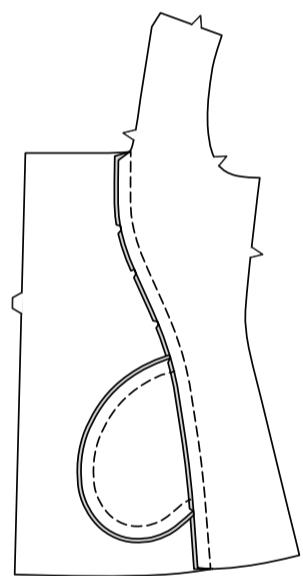
Stecken Sie das seitl. Vorderteil RECHTS AUF RECHTS auf das vordere Futter, wobei die Kerben übereinstimmen und schneiden Sie dabei zur festen Steppnaht ein, wie nötig. Heften. Nähen Sie. Bügeln Sie die Naht zum Vorderteil hin.
