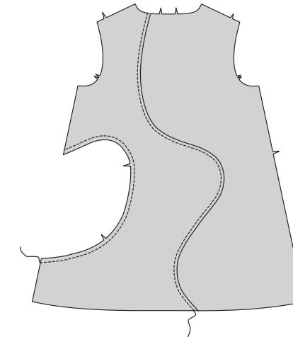
14. Das UNTERE LINKE RÜCKENTEIL (8) auf das linke Rückenteil aufstecken, die Passzeichen treffen aufeinander, das linke Rückenteil, wo nötig, entsprechend einschneiden. Mit 1,3 cm Nahtzugabe steppen. Nahtzugaben ins linke Rückenteil bügeln.
