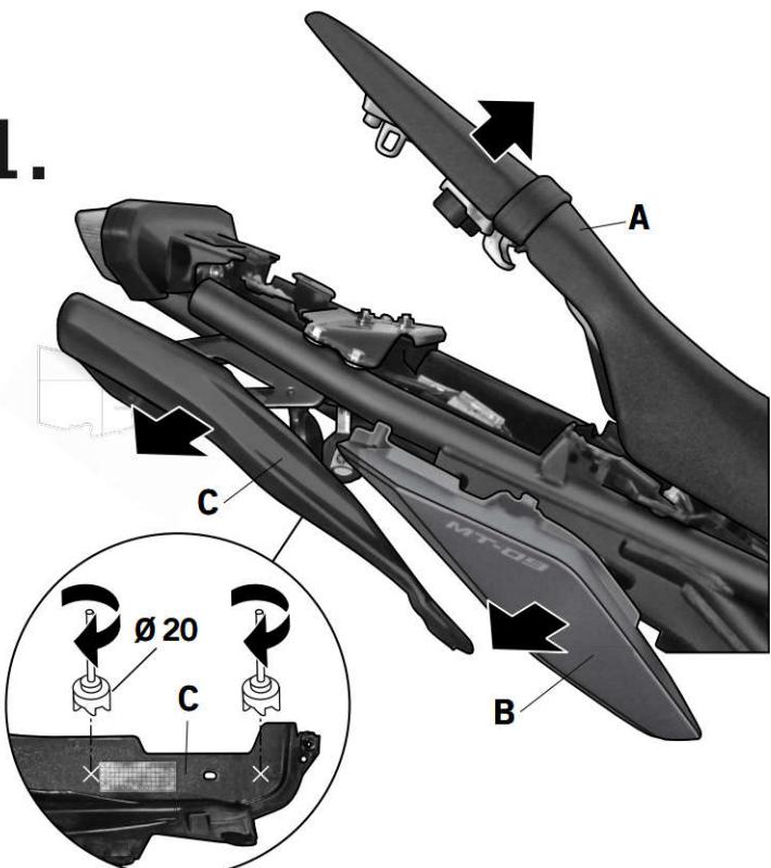
(E) Abrir el asiento (A). Desmontar las tapetas laterales (B). Desmontar los carenados laterales (C) y realizarles los dos agujeros marcados a Ø20. Montar los carenados laterales (C) y las tapetas laterales (B).
