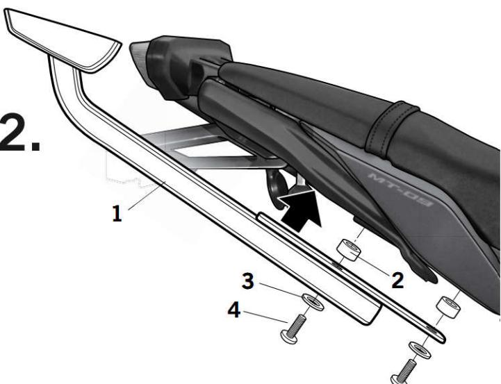
(E) Montar los soportes KIT TOP (1) mediante los distanciadores (2), las arandelas (3) y los tornillos (4). Cerrar el asiento (A).
